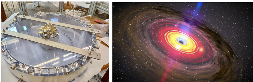
Fig 1: Dispositif expérimental 'Kepler-2fluids' (gauche) permettant de modéliser l'écoulement turbulent de gaz observé autour des trous noirs et proto-étoiles (droite).
