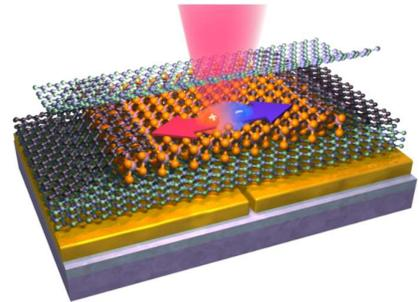
*Dispositif optoélectronique à base de matériaux 2D*
